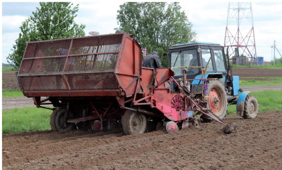
В агрегат разом загружается до двух тонн семенного материала.
