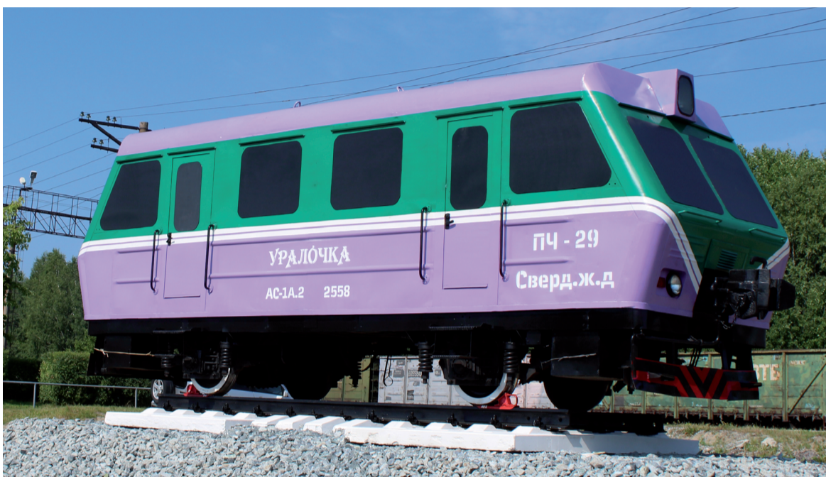
АС-1А.2 «Уралочка» - доработанная модель автомотрисы серии АС-1А, отличается исполнением кузова и ходовой частью. Выпускалась на Пермском моторовозоремонтном заводе.
